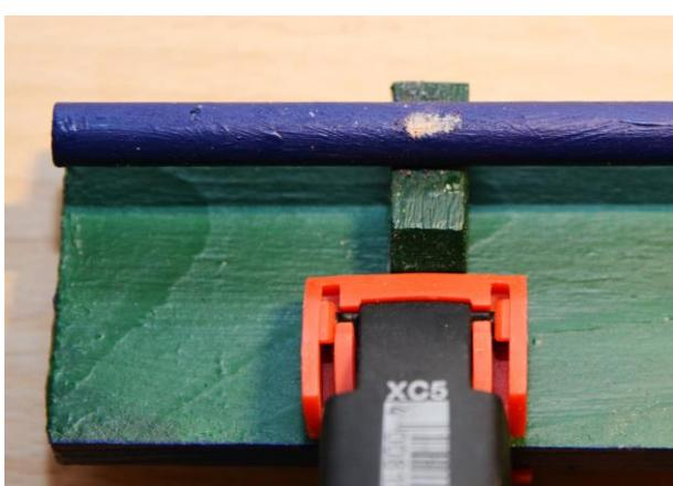
Legen Sie nun den Stab in die vorbereitete Aufnahme und schleifen Sie an der Leimstelle die Farbe leicht ab. Drehen Sie für das Leimen den Stab so, dass die Stelle ohne Farbe in die Aufnahme geklebt werden kann.
