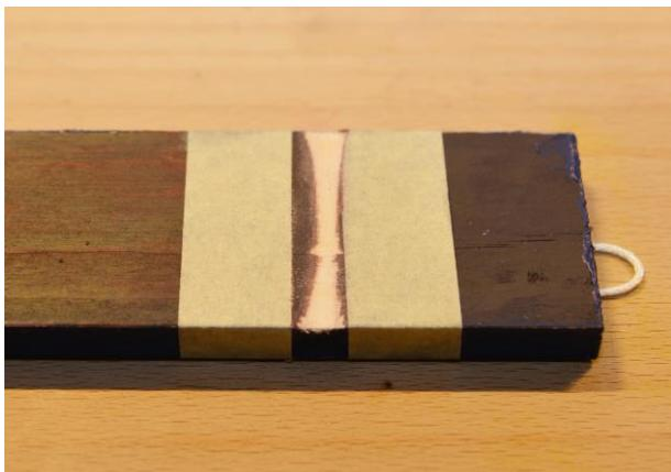
Schleifen Sie die Farbe an der Stelle, an der die Aufnahme für den Stab befestigt wird leicht ab. Dazu einfach etwas Malerklebeband aufkleben und dazwischen schleifen. Wiederholen Sie das auch am unteren Ende des Stabes.
