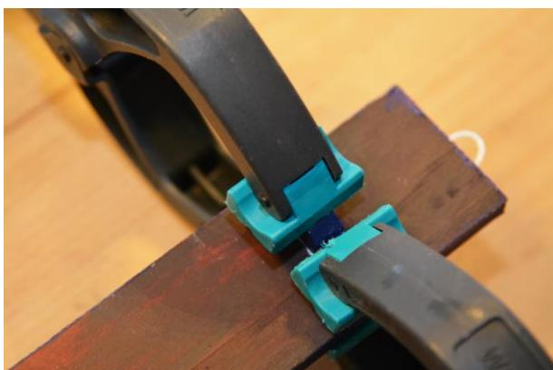
Kleben Sie nun die beiden vorbereiteten, farbigen Teile auf die Leiste. Und zwar so, dass die Aussparung für den Stab sich auf der linken Seite befindet. Pressen Sie gut fest und lassen Sie es 20' trocknen.
