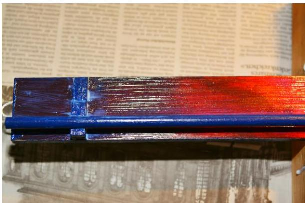
Lackieren Sie nun das ganze Barometer auf einen Schlag. Keine Angst, die Pinselstriche des Lacks werden in getrocknetem Zustand nicht mehr sichtbar sein.
