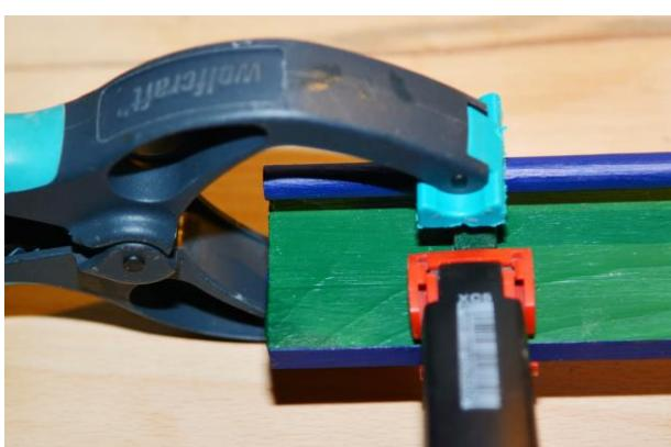
Kleben Sie nun den Stab in die vorbereitete Aufnahme. Pressen Sie wieder gut an und lassen Sie es 20' trocknen.
