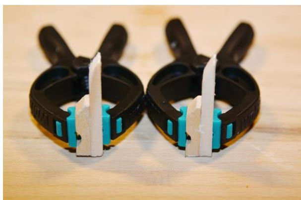
Leimen Sie die beiden Teile zusammen und lassen Sie sie gepresst gut trocknen (20').
